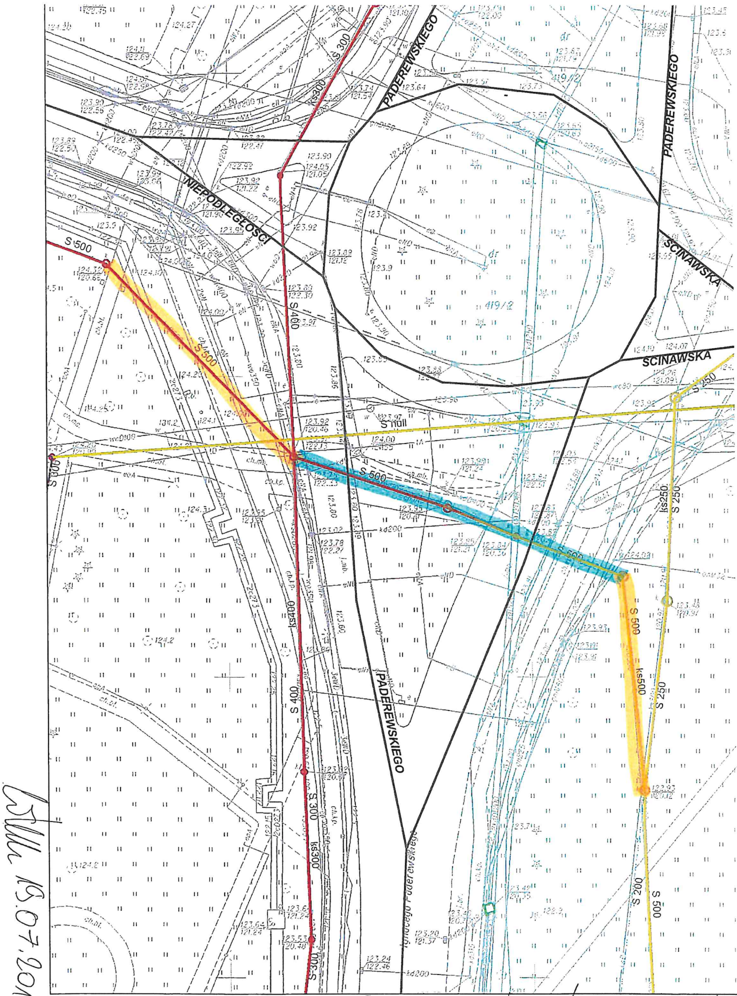
SIG 0211.0011.2011 1:600 Rondo Paderewskiego/Niepodległości całkowita długość 140mb, w tym 59 mb żelazo i 81mb beton
